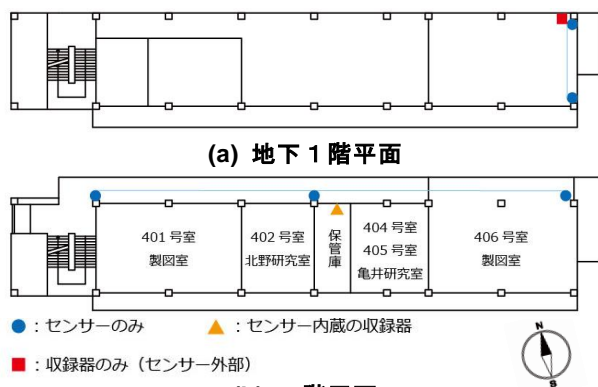
図1 強震計設置箇所(4号館)
